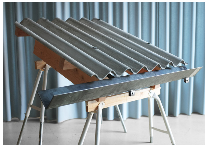
Materialeprøve: tag i genanvendt afrenset fibercementplade fra industri.
