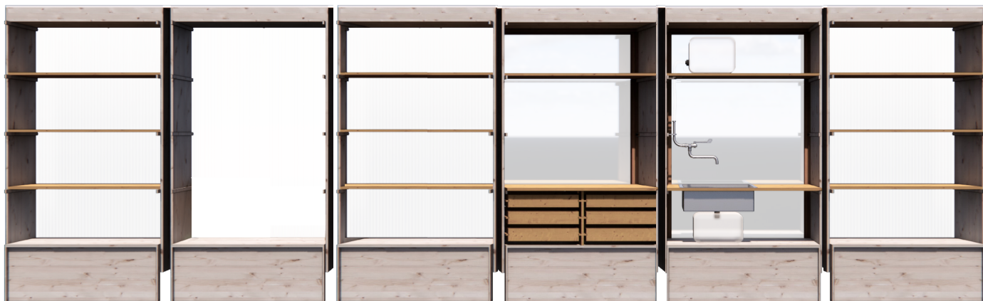
Indbyggede funktioner i bagvæg: reoler, bænke, vask og arbejdsbord med skuffer.
