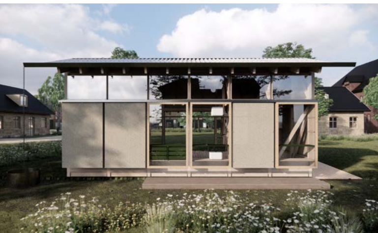
Værkstedet bagfra. Skydevinduer kan åbnes indefra. Trædæk giver adgang til indbyggede funktioner.
