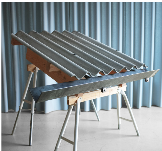
Materialeprøve: tag i genanvendt afrenset fibercementplade fra industri med tagrende i stål.
